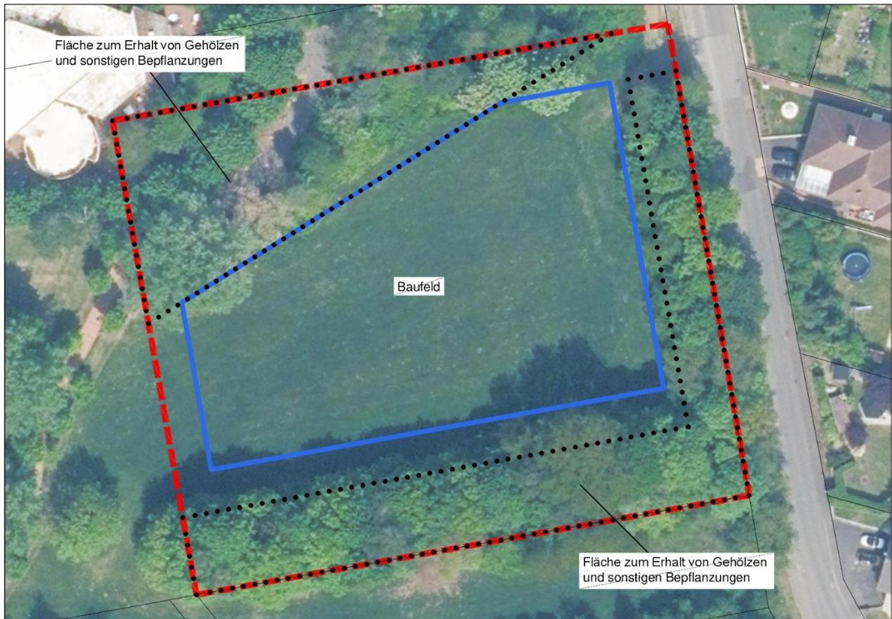
Abbildung 8 Überlagerung des Luftbildes mit den zeichnerischen Festsetzungen der 7. Änderung des B-Plans Nr. 10; Rot: Geltungsbereich B-Planänderung, Blau: Baufeld, Schwarz gepunktet: Flächen zum Erhalt von Gehölzen und sonstigen Bepflanzungen.
